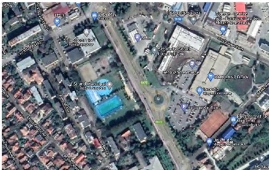
Figura 3.21. Sens giratoriu “dezaxat” – realizat pentru “favorizarea” accesului la Kaufland. Sursa: Google Maps.
