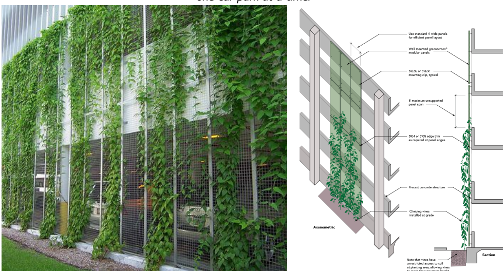
Figura: Exemplu de tratare a fațadelor parcarilor supraetajate. Sursa: https://www.rdcollab.com/ Detalii pereți verzi amplasați pe parcarile supraetajate. Sursa: Design Guidelines for Green Facades on Parking Structures, Greenscreen Engineering Nature
