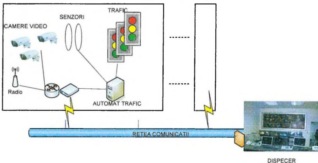
Figura 4 - Schema tipica de principiu a sistemului de management a traficului de oras
