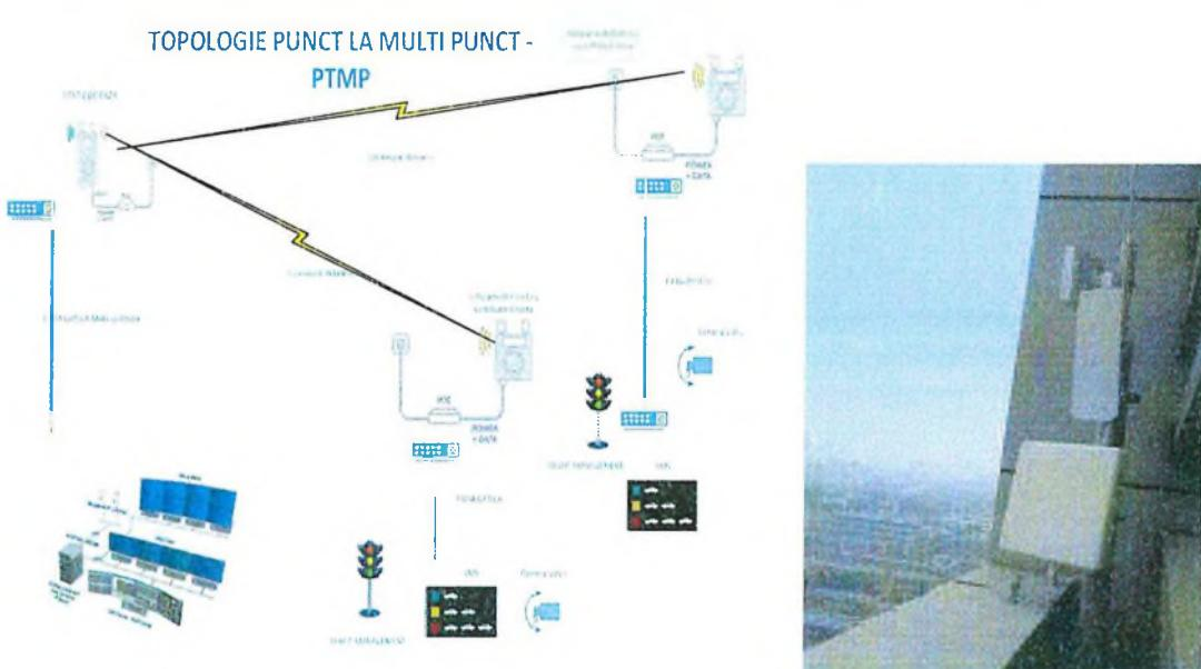
Figura 11 – Arhitectura modelului de comunicatii radio P-MP / Echipament RF instalat pe cladire
