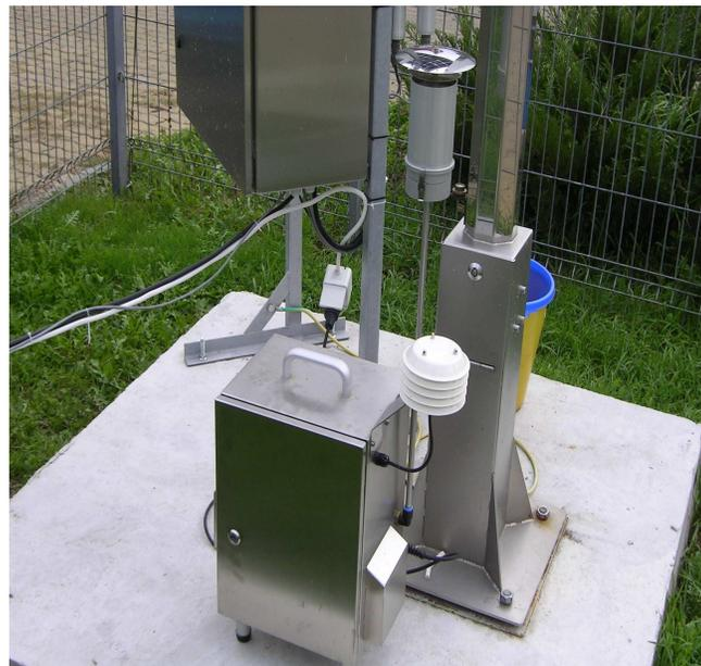
**Fig. nr. 1.2.6.1.2.1. Sistem prelevare pulberi în suspensie LVS3 utilizat la determinarea PM<sub>10</sub>**
