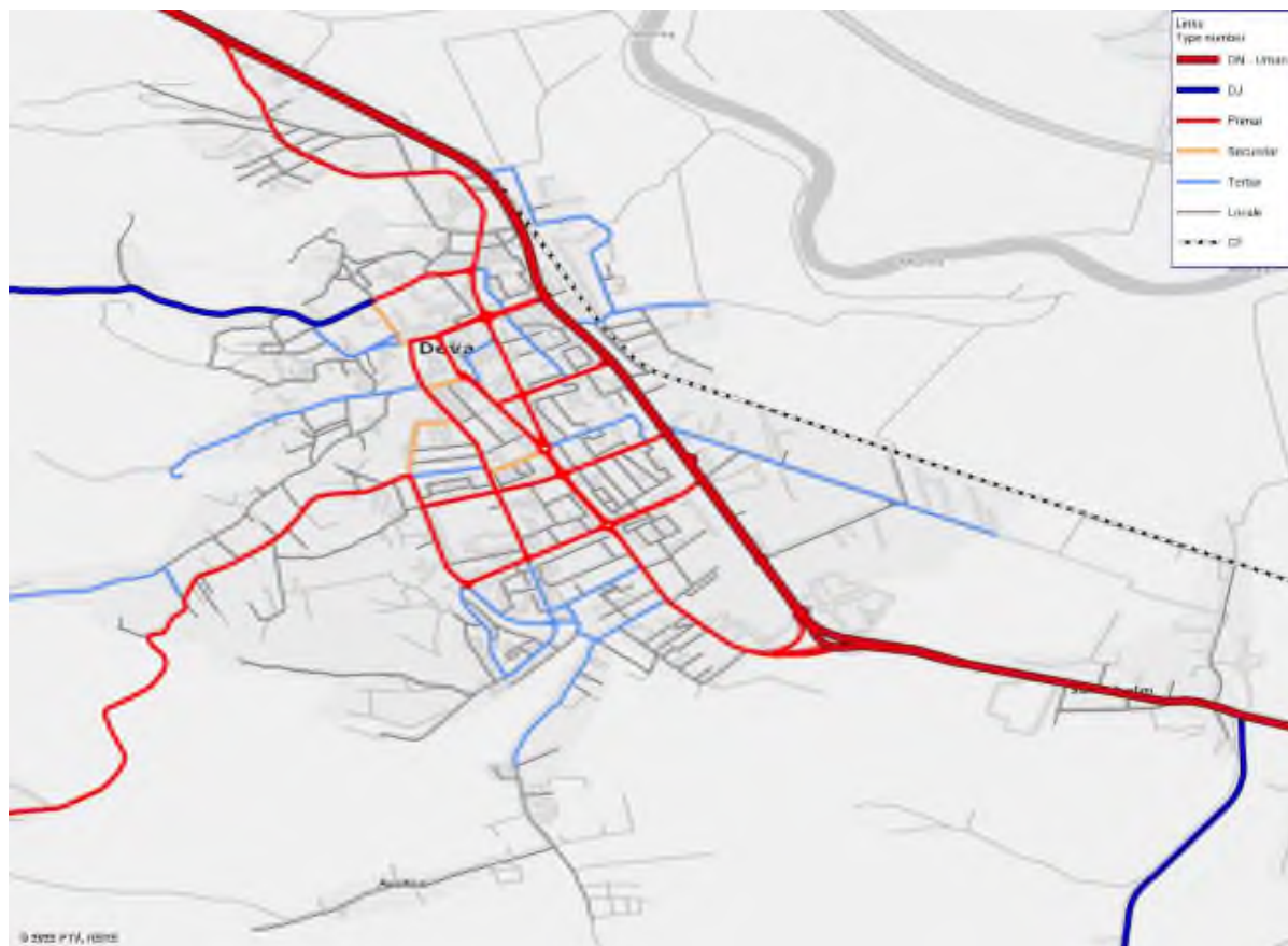
Figură 3-11 Structura rețelei rutiere în cadrul modelului de trafic pentru municipiul Deva
